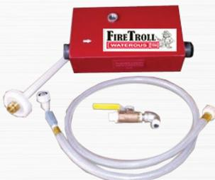
El Sistema dosificador de espuma Fire Troll de Waterous puede insertarse en una manguera en cualquier ubicación, pero generalmente se inserta en la tubería entre la salida de la bomba y el carrete. El sistema Fire Troll le permitirá mantener un flujo continuo sin exceder 1% de concentración de espuma con presiones y volúmenes de agua variables.
